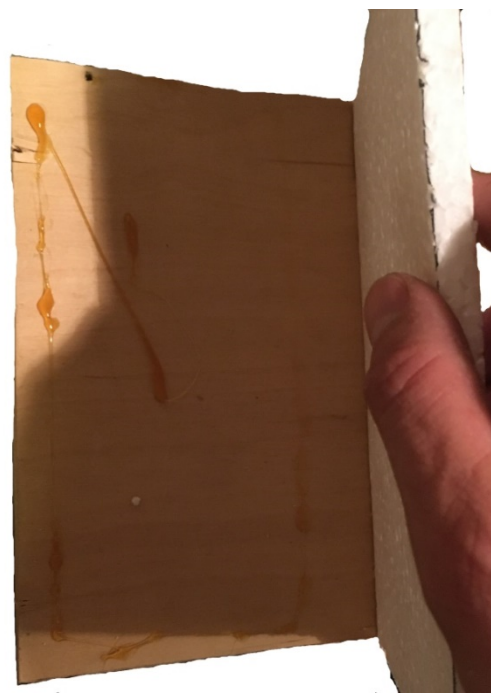
Abbildung 12: Kleben der Styroporplatten
